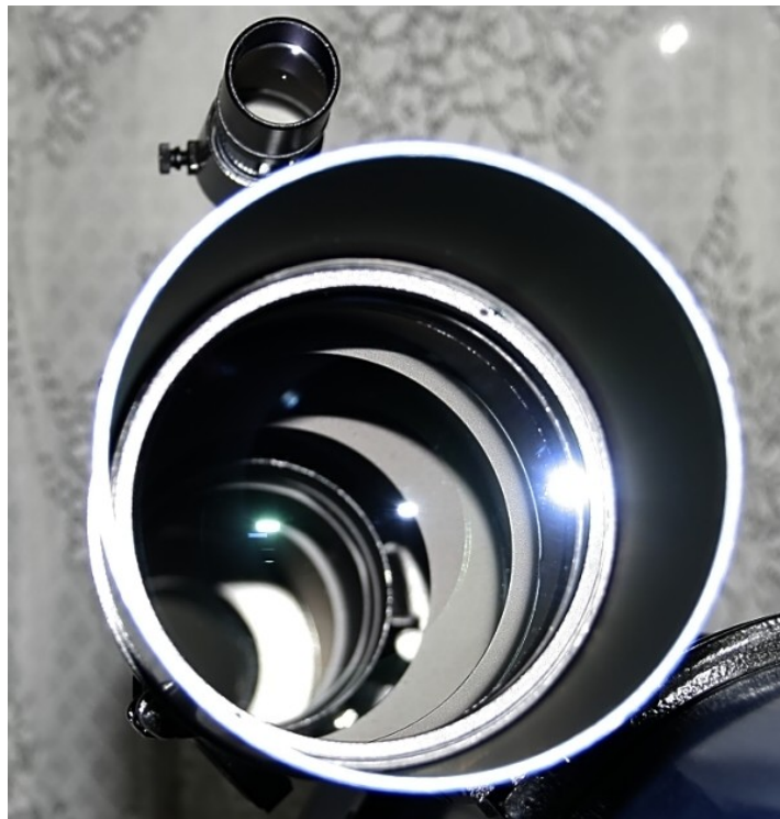
Imagine a obiectivului, cu reflexiile in straturile depuse pe suprafetele optice. Se observa diafragmale montate la interiorul tubului, care asigura o foarte buna eliminare a reflexiilor parazite. In stanga sus se observa luneta cautator 6x30 montata in paralel.
